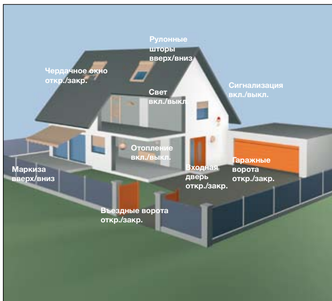
Рис. 1: Управление дверьми, гаражными и въездными воротами, маркизами и мансардными окнами, рулонными шторами, освещением и отоплением при помощи систем радиуправления Hörmann.
